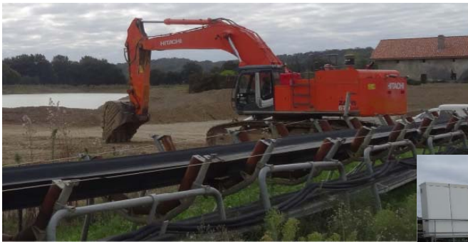
← Extraction du gisement et transport par bandes transporteuses ↓
