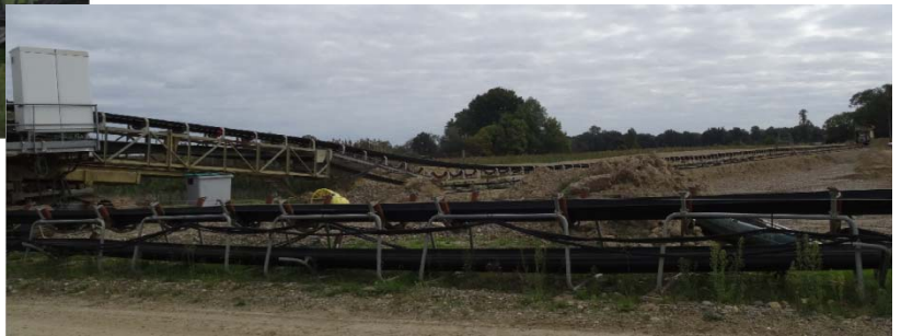
← Extraction du gisement et transport par bandes transporteuses ↓
